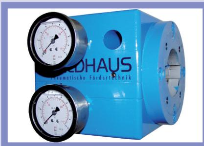
Drei Regelscheiben sind im Regelbereich mit  $\text{Al}_2\text{O}_3$  ausgekleidet. Die mittlere Regelscheibe wird mittels Antrieb bis zu 15 mm verstellt und dichtet durch O-Ringe den Regelspalt zur Atmosphäre ab.
