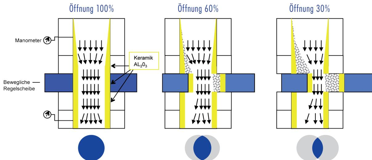
Das ruhende Material vor dem Regelspalt sorgt für ein strömungsgünstiges und verschleißbares Einführen in den mit Ingenieurkeramik ausgekleideten Regelspalt.
