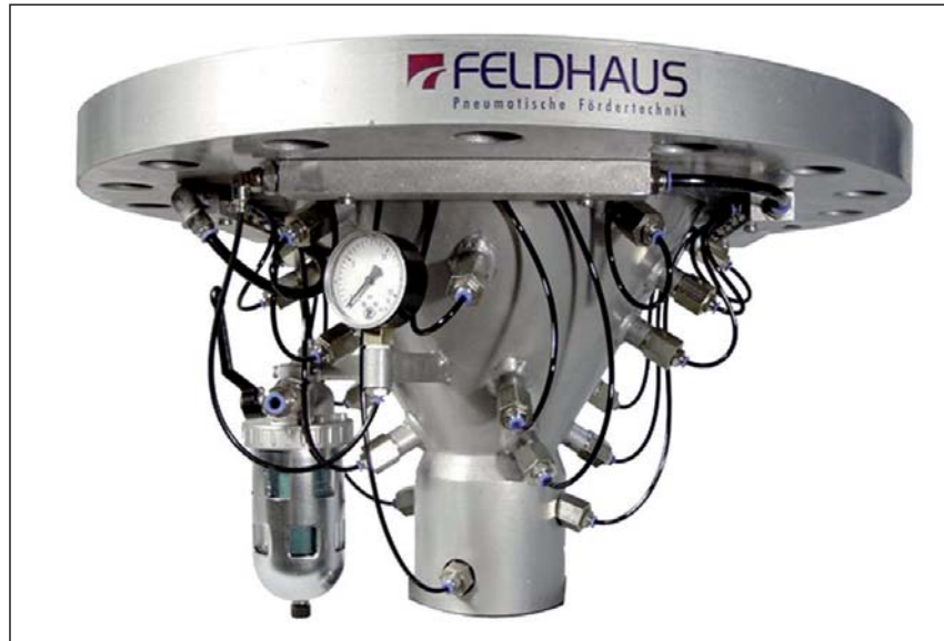
圖1 使脫硫劑流態化的FFC流態化錐體
